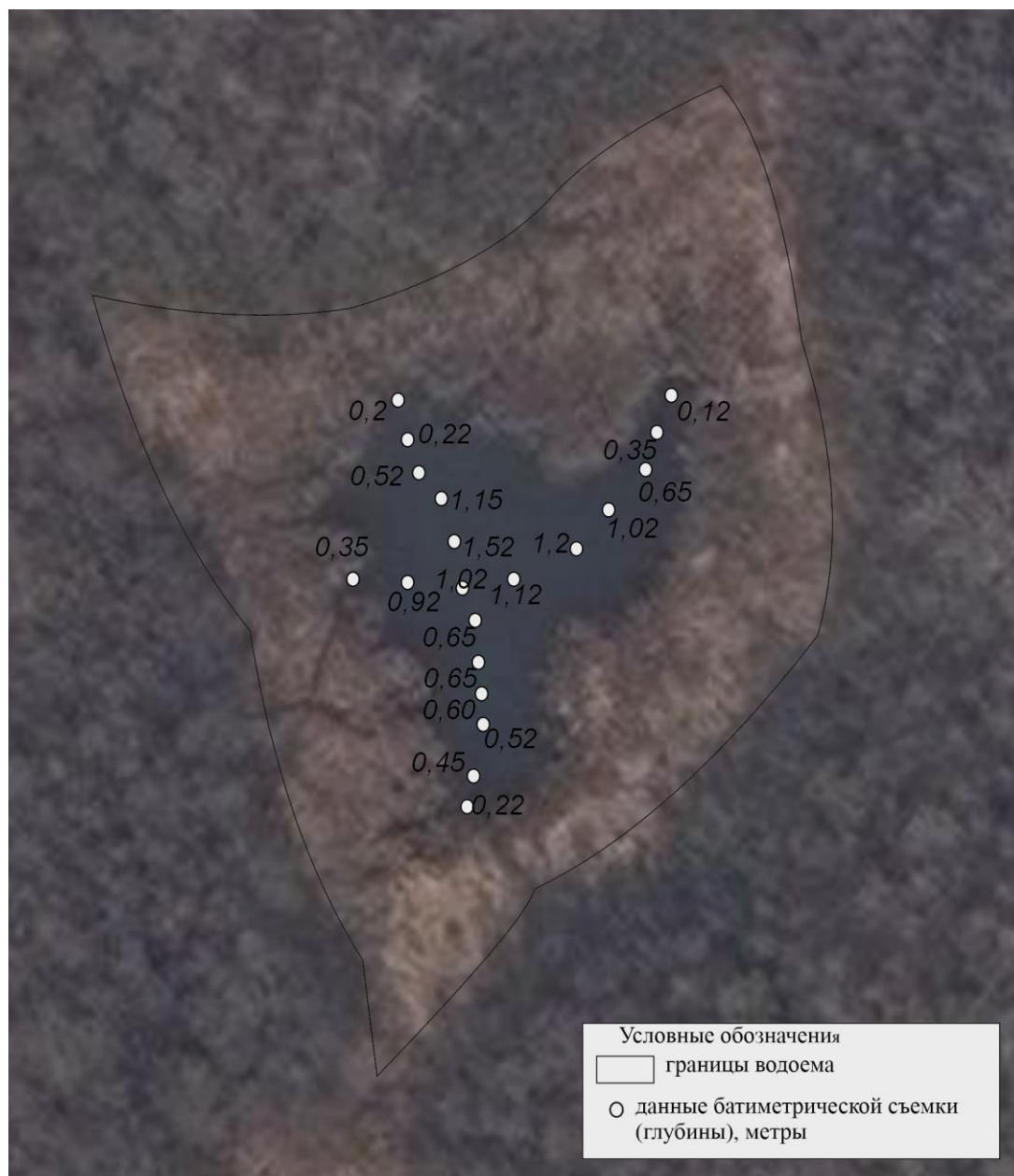
Рисунок 1.3 – Карта-схема батиметрических измерений на участке застройки пруда «Центральный»
